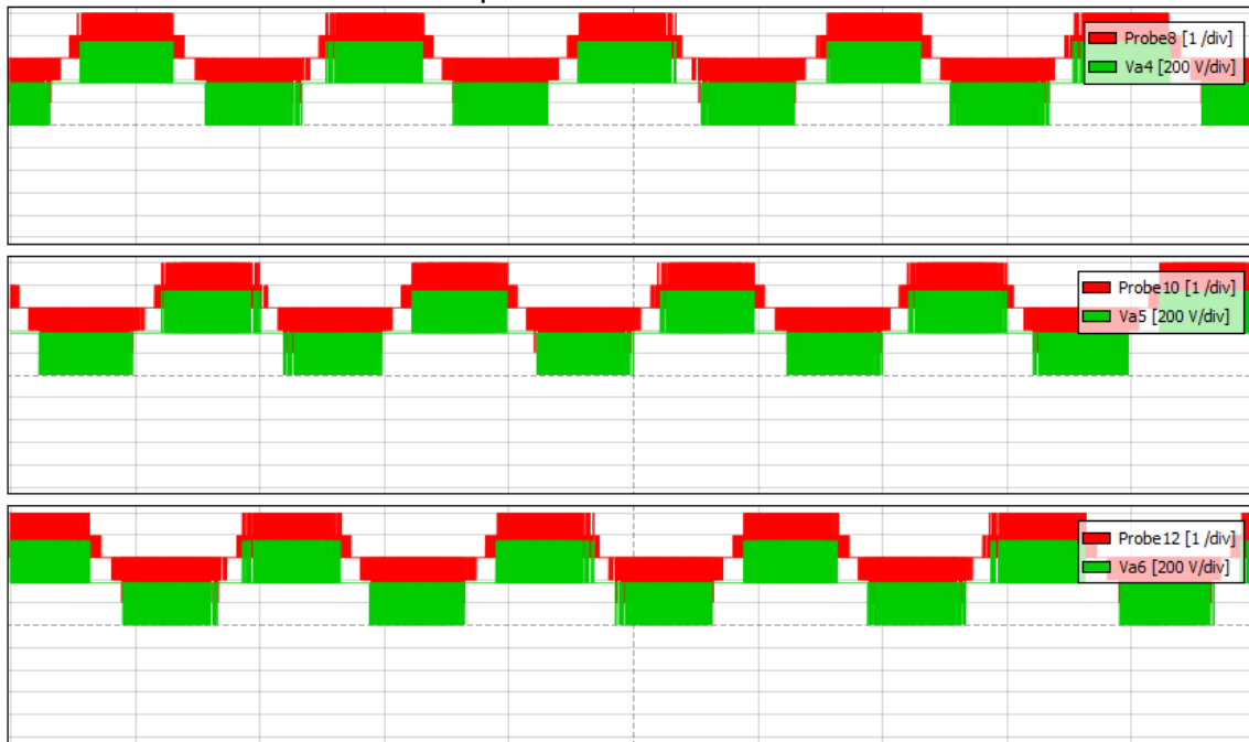
Figure 78 : Tension en sortie de l'onduleur pour les trois phases. ( 120^\circ entre les phases)
