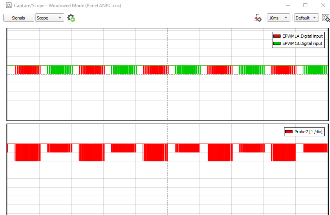
Figure 74 : Décodage des signaux reçu. Le signal A à un gain de 2 et le signal B à un gain de 1. La somme des deux donne une valeur entre 0 et 3 sur le deuxième graphique.
