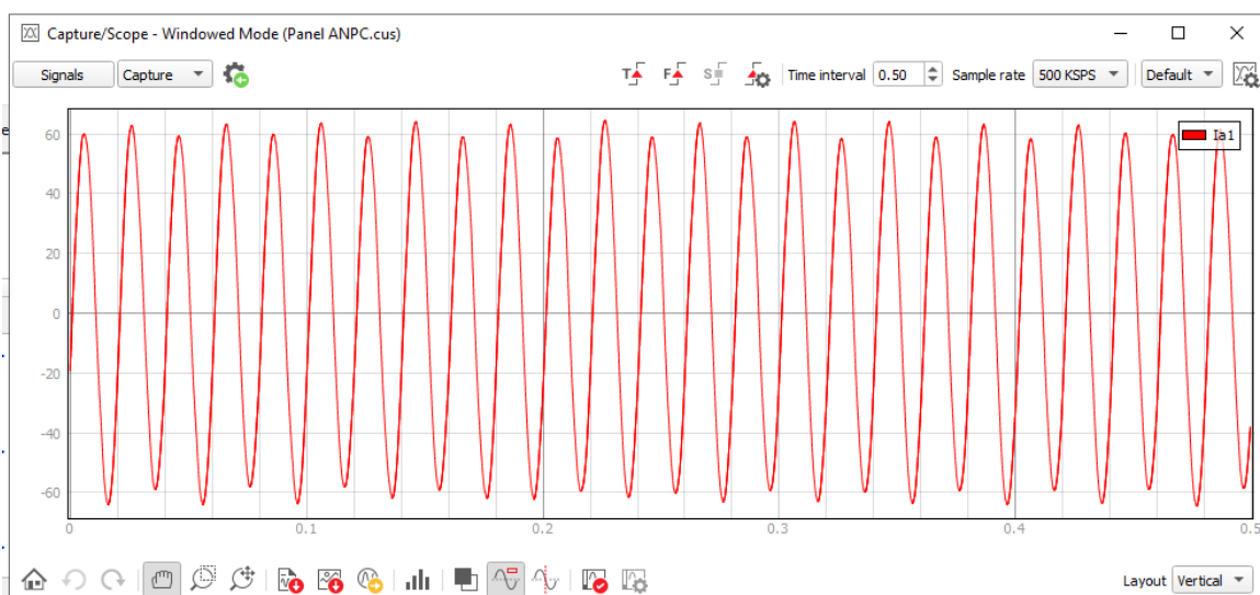
Figure 89 : Au sommet de l'image il y a la tension qui s'équilibre et sur oscilloscope il y a le courant en sortie du système
