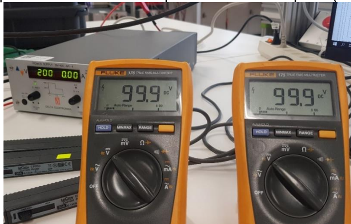
Figure 130 : Equilibrage entre Bus DC supérieur et inférieur (gauche = sup, droite = inf) lorsque l'installation est à l'arrêt
