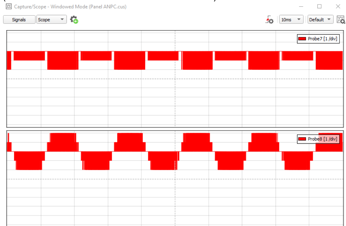
Figure 75 : Le signal décodé vient sur la state machine et en sortant de cette state machine nous allons avoir des sorties activées ou non mais également un numéro d'état entre 1 et 5. Voir chapitre 5.1
