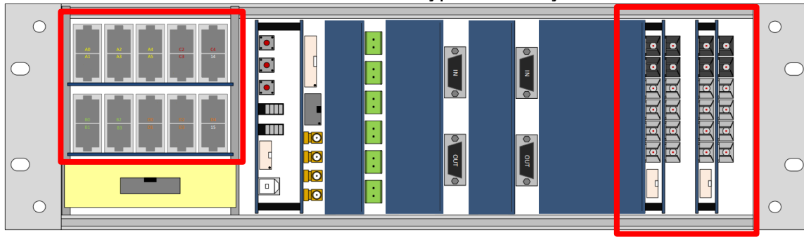
Figure 149 : Rack Poetic avec tous les composants, mais surtout les mesures avec prise Ethernet à gauche et les fibres optiques à droite
