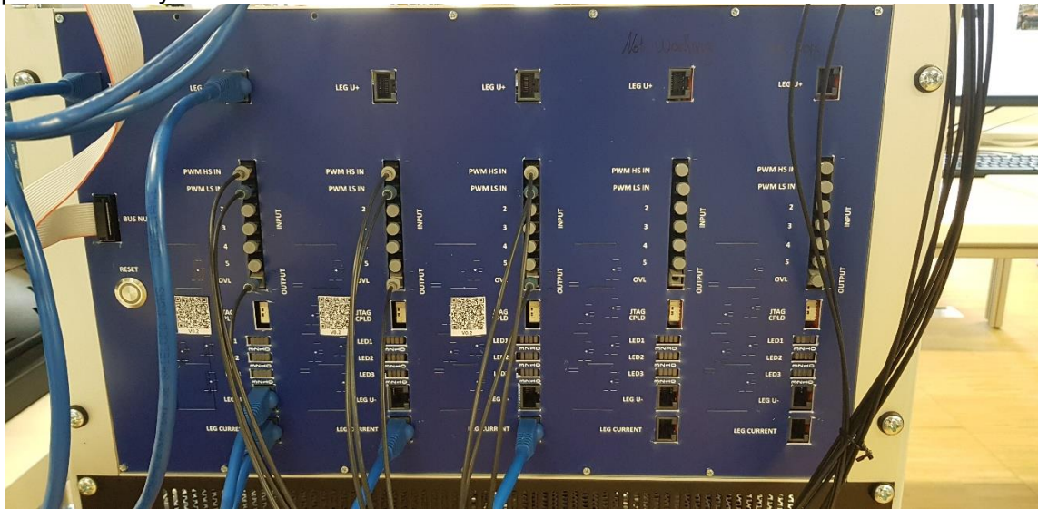
Figure 7 : Face avant des cartes de puissances avec les branchements fibres optiques et mesures
