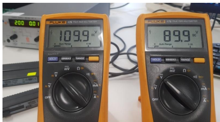
Figure 131 : Equilibrage entre Bus DC supérieur et inférieur (gauche = sup, droite = inf) lorsque l'installation est à des consignes de courants I_d et I_q = 0A (Tensions instables, mais avec l'équilibre des tensions ce problème n'existe plus)
